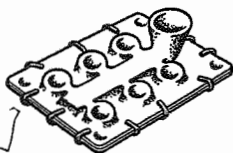
1859 Оболочковая форма Shell mould
